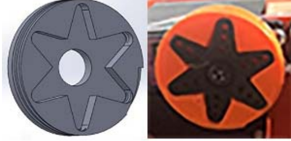
Şekil 4. SolidWorks mekanik tasarım yazılımı üzerinden tasarlanan servo boynuzu (sol panel) ve basılan servo boynuzu (sağ panel) (Servo horn designed through SolidWorks mechanical design software (left panel) and printed servo horn (right side))
