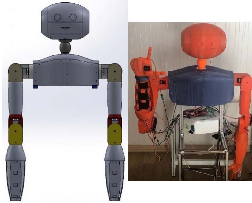
Şekil 2. SolidWorks mekanik tasarım yazılımı üzerinden geliştirilen EC-Tema insansı robotu (sol panel) ve 3D yazıcı ile basılan EC-Tema insansı robotu (sağ panel) (EC-Tema humanoid robot developed through SolidWorks mechanic design software (left side) and EC-Tema humanoid robot printed with 3D printer (right side))
