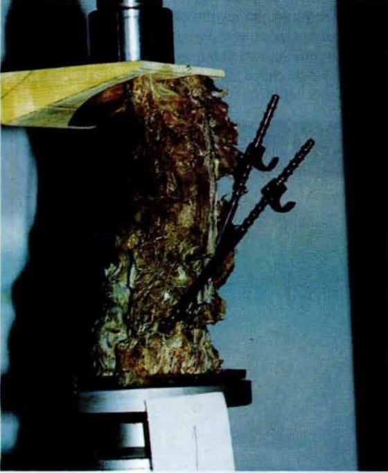
Resim 4: Harrington Distraksiyon Rotu uygulanan omurganın basma deneyi sonunda yetmezliğe girmesi.
