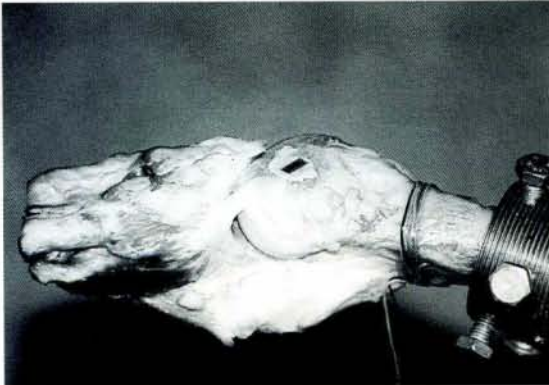
Resim 1: M. popliteusun femoral tarafına yapıştırılmış strain gauge ve femur tutucusu görülmektedir
