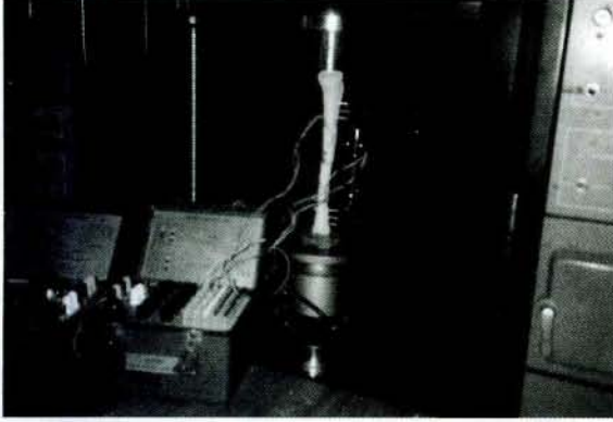
Resim 1: Dinamik aksiyel fiksator ve kemik modelimizin Instron test makinesi ile ölçümü görülmektedir
