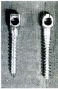
Şekil 1: CD (Yiv derinliği: 1mm) ve Synergy (Yiv derinliği: 1.8mm) sistemin vidaları
