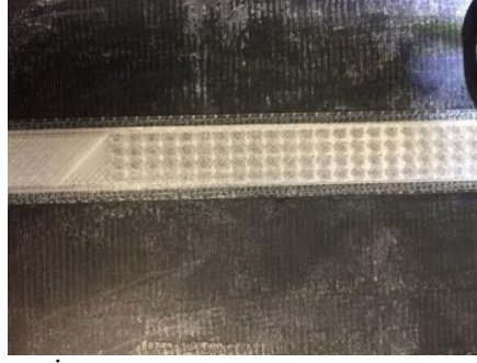
Şekil 5. Kirişin Şeffaf Görüntüsü ile İç Yapısının Görülmesi ve 3B Yazıcıda İmalat Süreci Tam Görünümü
