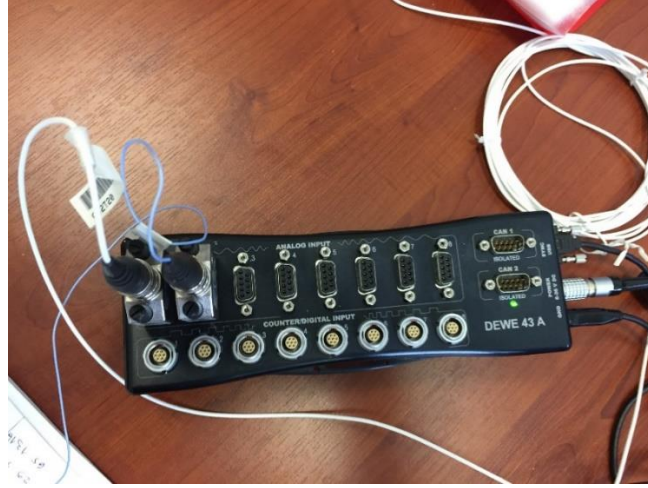
Şekil 10. Çalışmada Kullanılan DEWE 43 A Veri Sistemi
