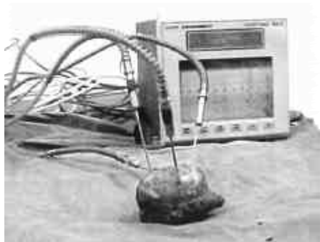
Şekil 1. A.B.B. PR 106 kayıt cihazı çimento ve kemik bölgelerindeki sıcaklık değişikliklerini kaydetmek amacıyla kullanıldı.
