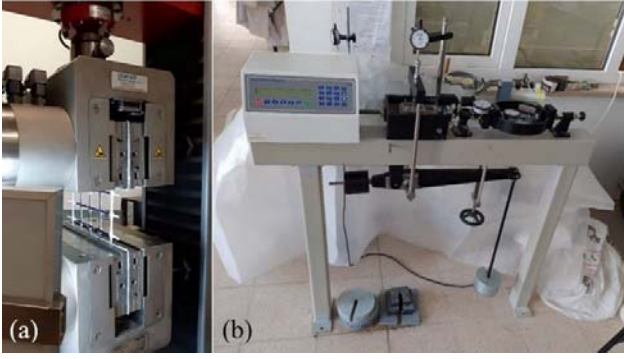
Şekil 4. a) Çekme testi cihazı, b) Kesme kutusu test cihazı (a) Tensile strength test device, b) Shear box test device)
