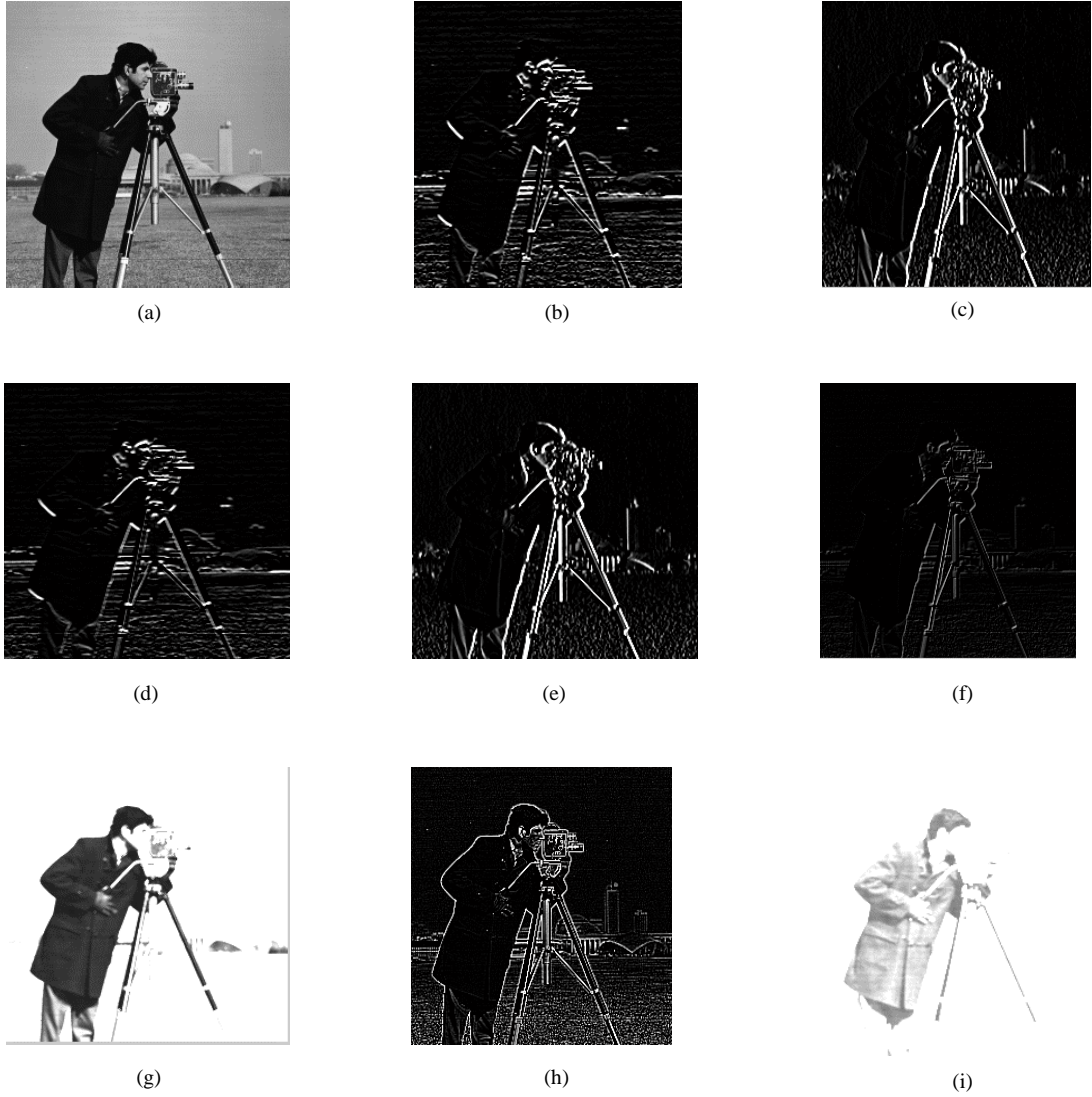
Şekil 8. 2D Konvolüsyon IP bloğunun imge üzerine uygulanması (a) Orijinal imge, (b)Yatay Sobel, (c)Dikey Sobel, (d) Yatay Prewit, (e) Dikey Prewit, (f)Kaydır ve Çıkart, (g) Alçak Geçiren, (h) Yüksek Geçiren, (i) Gauss
