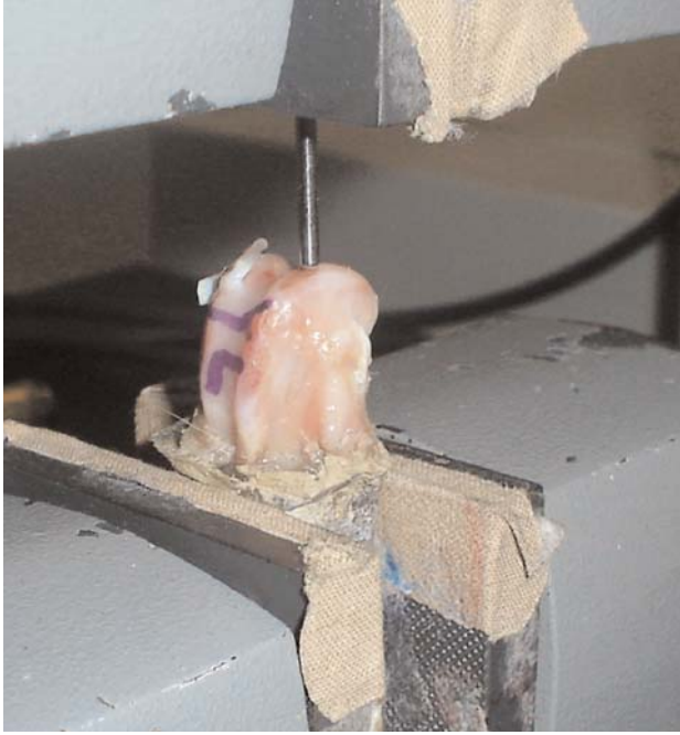
Şekil 2. Örneklerin sıkıştırma test cihazında bir araya getirilmesi. [Bu şekil, derginin www.aott.org.tr adresindeki çevrimiçi versiyonunda renkli görülebilir]
