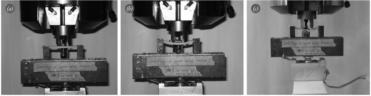
Şekil 2. (a-c) Dört-nokta eğme testinde örneğin kırılması.
