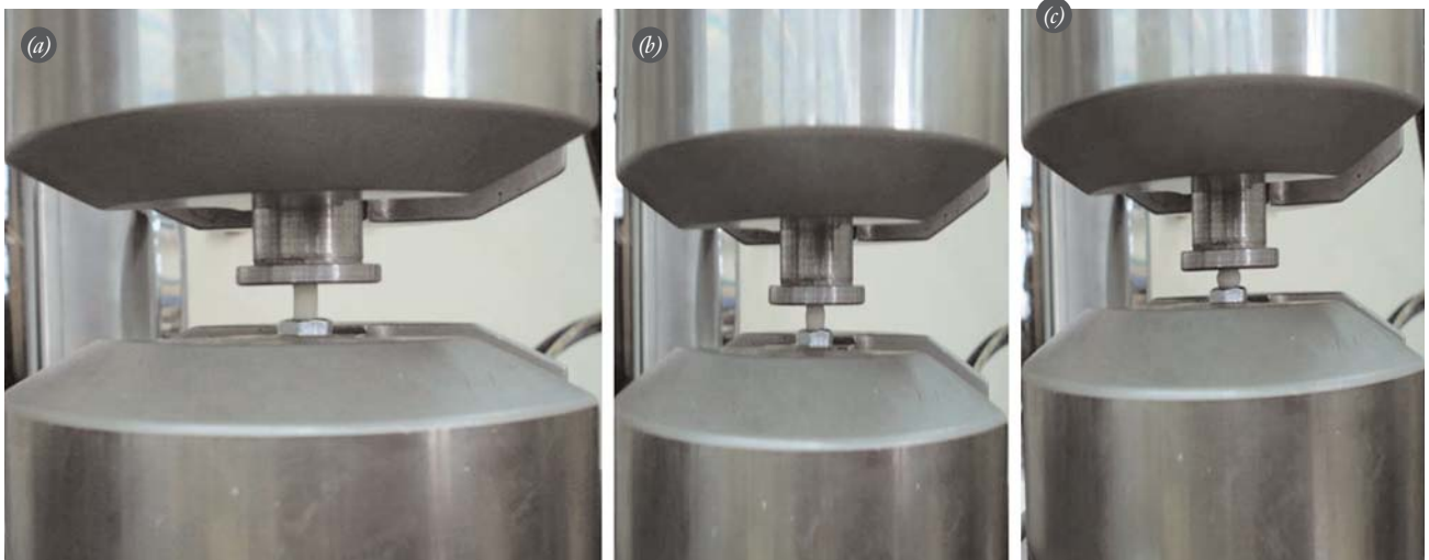
Şekil 3. (a-c) Basma testinde örneğin deformasyonu. [Bu şekil, derginin www.aott.org.tr adresindeki çevrimiçi versiyonunda renkli görülebilir]
