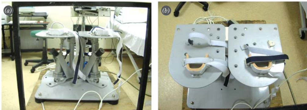
Şekil 2. (a-b) Ayak bileği inversiyon yaralanması simülasyon cihazı.
