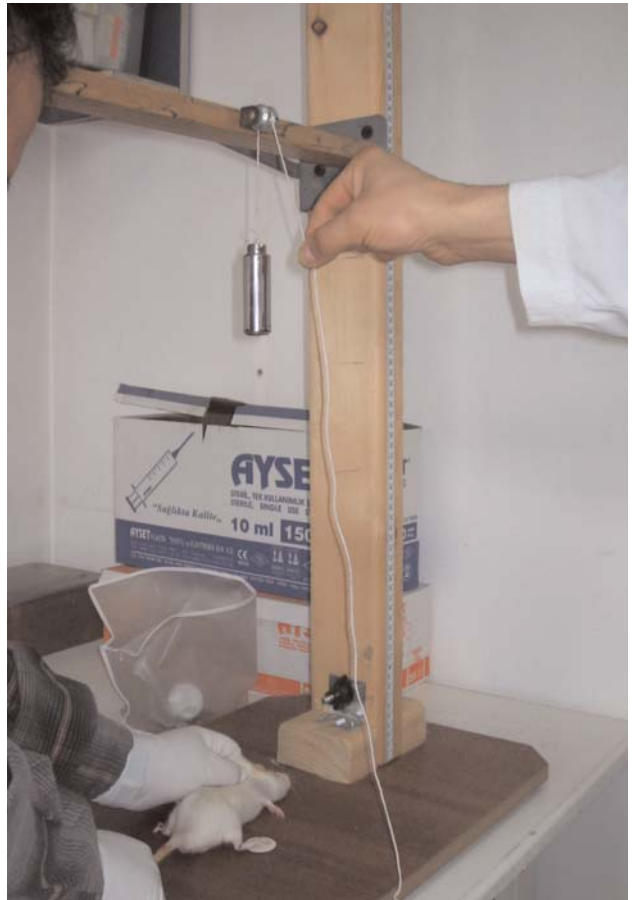
Şekil 2. Ağırlık düşürülerek travmatik ödem oluşturulması.
