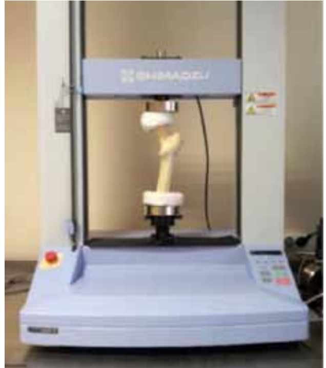
Sekil 5. Kemik modelin test makinesindeki görüntüsü. [Bu şekil, derginin www.aott.org.tr adresindeki çevrimiçi versiyonunda renkli görülebilir.]
