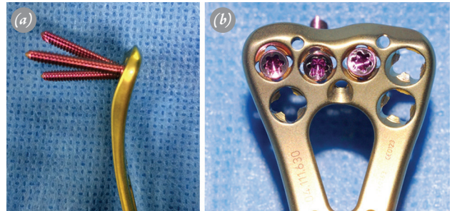
Sekil 2. Üç farklı açıda- 15^\circ yukarıya doğru, 0^\circ ve 15^\circ aşağıya doğru- vidalar ve plak arasındaki kilidi gösteren fotoğraf. (a) Plak deliklerinin dişleri ile üç farklı açılı vida başlarının iyi oturmasını gösteren fotoğraf. Uygun açı içerisindeki kaldıraç plak ve vidalar arasındaki kilitleli mekanizmayı kırmaz (b). [Bu şekil, derginin www.aott.org.tr adresindeki çevrimiçi versiyonunda renkli görülebilir.]
