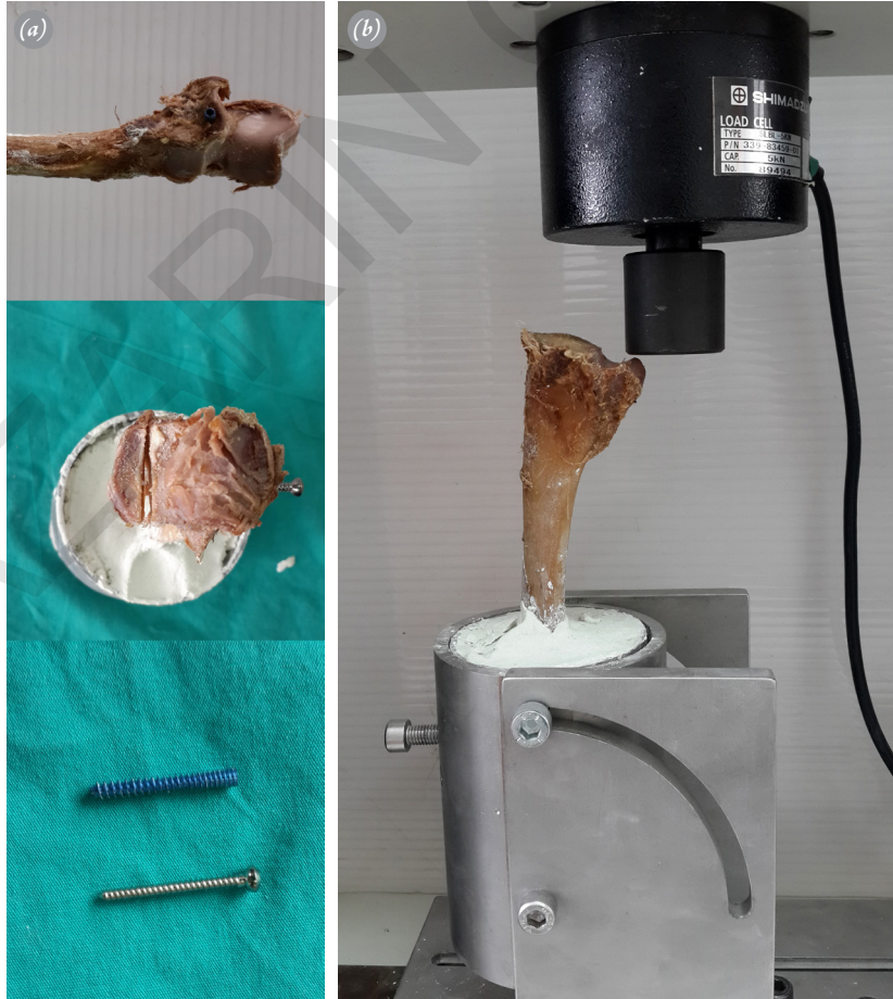
Sekil 1. (a) Test edilen vidalar. (b) Test düzeneği. [Bu şekil, derginin www.aott.org.tr adresindeki çevrimiçi versiyonunda renkli görülebilir.]
