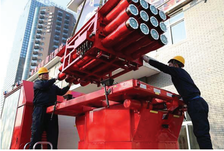
Şekil 6. İtfaiye Aracı Üzerinde Bulunan Kaideye Yüklenmiş Yangın Söndürme Roketleri [13]
