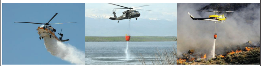
Şekil 3. Los Angeles İtfaiyesine Ait Sikorsky S-70C Tip Tanklı Bir Helikopter ve Kovalı Helikopterler
