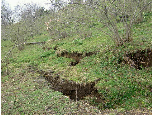
Şekil 7: Kayma Sonucu Şev Gerisinde Oluşan Gerilme Çatlakları Figure 7: Tension Cracks Occurred on Surface due to Slope Failure
