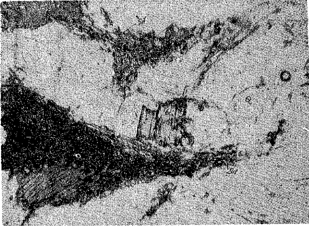
Şekil 4 : Diyateksitlerde biyotitlerin kenarında gelişen prizmatik/fibro tip sillimanit (T.N., X50). Sil: Sillimanit, b: biyotiti, Q: kuvars
