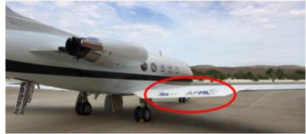
Şekil 6. Flexsys şirketi tarafından geliştirilen esnek kanat flapı (Acar ve Oktay, 2018).
