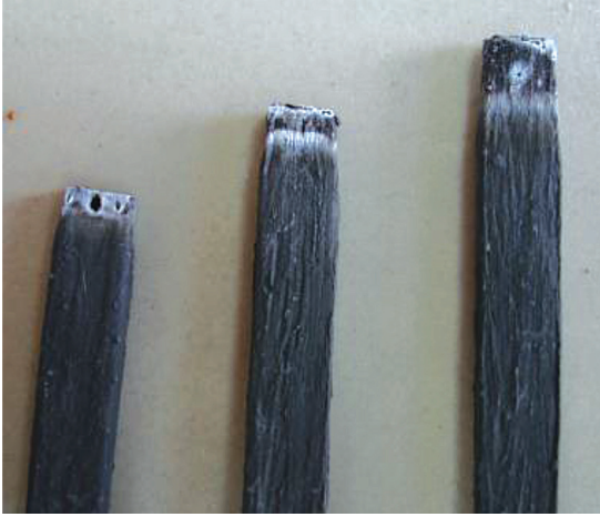
Resim 2. %45, %50, %55 oksijen konsantrasyonu ile yakılan numuneler
