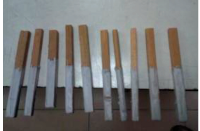
Resim 3. Magnezyum borat katkılu boya ile hazırlanan ahşap numune
