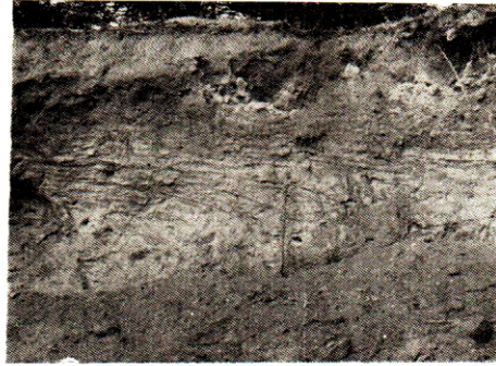
Resim: 3. Toprağın donması ile meydana getirdiği basınç neticesinde teşeküleden «Zersatzverziehungen ve «Zersatz»
