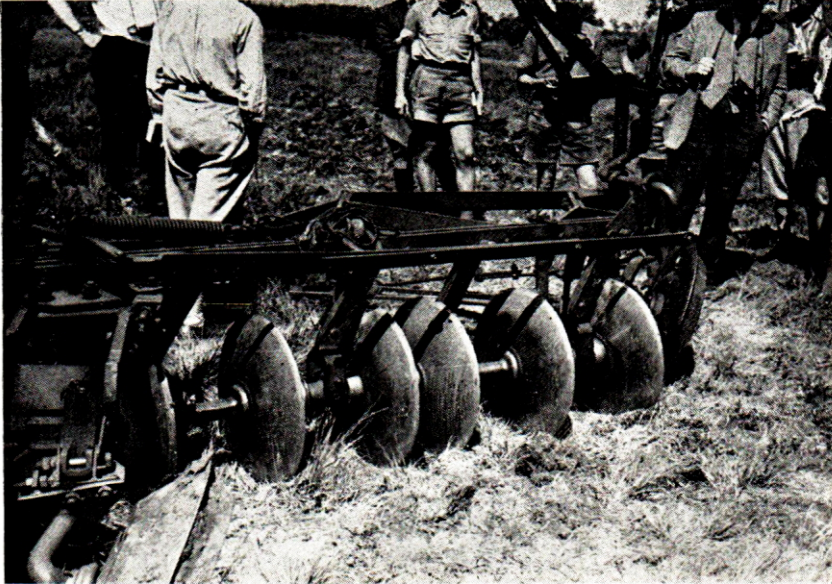
Resim 2. Kuvvetli ve sık toprak örtülerinin (Molinia, Calluna, Vaccinium v.s.) bertaraf edilmesi için kullanılan «Roburit» adlı disk pulluđu. Kuzey Almanya, Fuhrberg orman işletmesi, 3 Ağustos 1952 (Photo F. Saatçiođlu)
