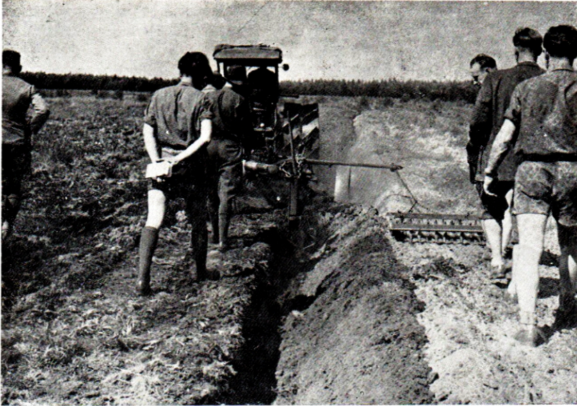
Resim 4. «Schlepperpflug - Waldmann» adlı pullukla toprağın 35 - 45 cm derinlikte işlenmesi. Pulluğun yanda çektiği «Notzonegge» adlı tırmık, bir evvelki pulluk çizgisi üzerine isabet eden toprağı tesviye eder ve tırmıklar. Kuzey Almanya, Fuhrberg orman işletmesi, 3. Ağustos 1952 (Photo F. Saatçioğlu)
