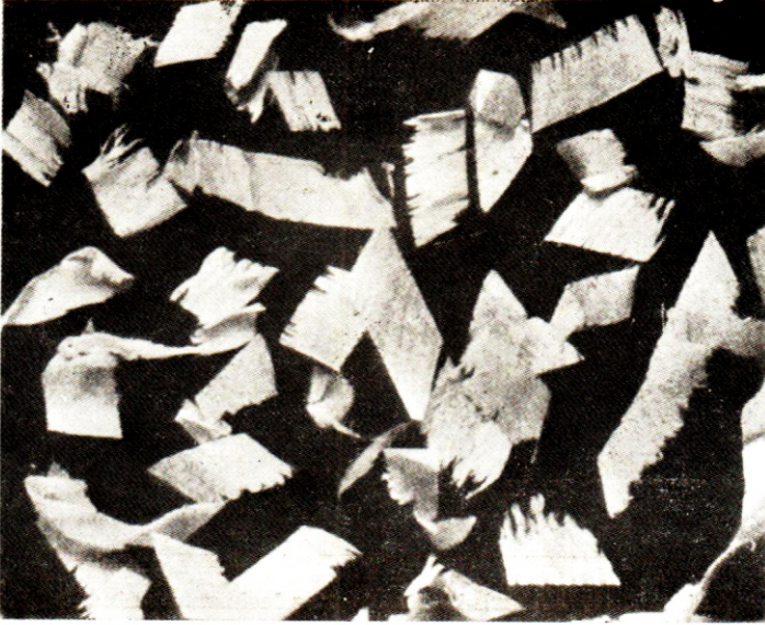
Resim 1 : Novopan Talaş levhalarının üst tabakalarında kullanılan, kesme suretile elde edilmiş yassı Lâdin talaşları.
