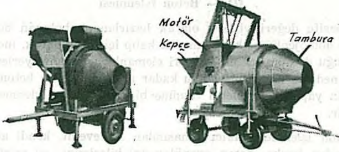
Resim : 5 Betonun karıştırılmasını sağlayan betoniyerler.
