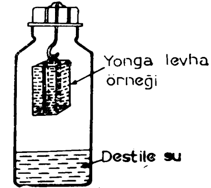
Abb. 1. WKI - Flaschenmethode für die Bestimmung der Formaldehydabgabe aus spanplatten. Şekil 1. Formaldehid ayrışmasının belirlenmesi için kullanılan WKI - Şişe Metodu.
