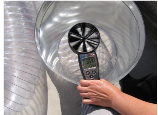
Şekil 7. Uygulama öncesi hızölçer ile yapılan hava testi Figure 7. Air test by a speedometer before fumigation
