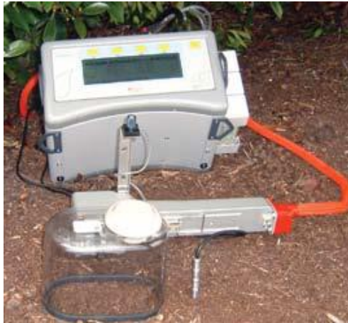
Figure 6. Soil respiration measurement (SR2000 Intelligent Portable Soil Flux System) Şekil 6. Toprak solunum ölçümü (SR2000 Taşınabilir toprak solunum ölçüm sistemi)
