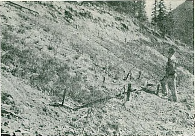
Şekil 7. Tohumlamadan 7 ay sonraki dolduru şevi deneme plotlarının görünüşü. Şevin profilini çıkarmak maksadiyle faydalanılan tel halat U demirleri arasına gerilmiştir.
