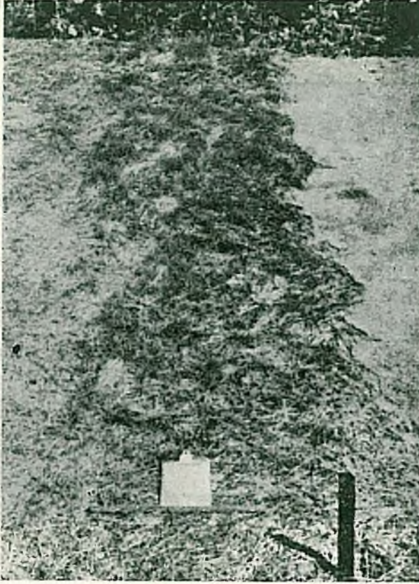
Şekil 10. 2 Nolu deneme karışımı ile tohumlanmış kazı şevinin ekimden 7 ay sonraki durumu.
