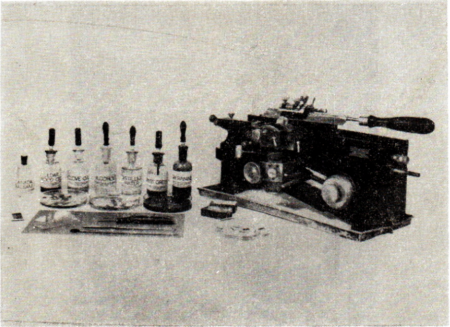
Şekil 4. Kızaklı bir mikrotom ve kesitlerin hazırlanmasında kullanılan lüzumlu yardımcı âlet ve kimyasal maddeler. (F.P.R.L., 1956).
