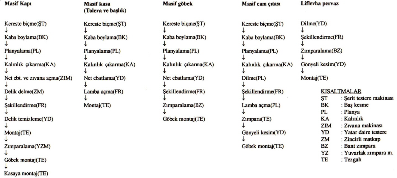
Şekil 3: Masif kapı, kasa ve pervaz üretiminde kullanılan makinalar ve iş akış şeması
