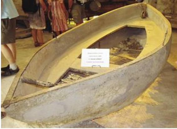
Resim 11. İlk betonarme uygulaması, tekne (Atabey, 2019:1)
