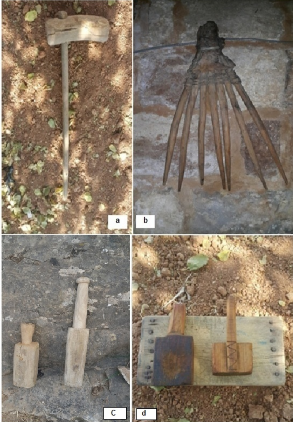
Ek 11. a) Dut ağacından ( Morus spp.) yapılmış mirkut adı verilen tokmak, b) dut ağacından yapılan melheb adı verilen yaba, c) dut ağacından yapılan ve yün yıkamada kullanılan Şünk (büyük), d) zeytin kırmada kullanılan Şünk (küçük)
