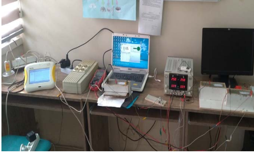
Şekil 2. Harçlara DC uygulanması (DC application on mortars)
