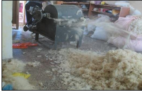
Fotoğraf 2. Yünün elyaf açma makinasından açılması (Karaman 2020)
