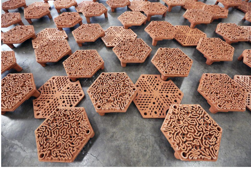
Resim 5. Hong Kong Üniversitesi'nden (HKU) bilim insanlarından oluşan araştırma ekibinin, Hoi Ha Wan Deniz Parkı'ndaki bir mercan resifini onarmak için geliştirdikleri altgen seramik karolar, (URL 19).
