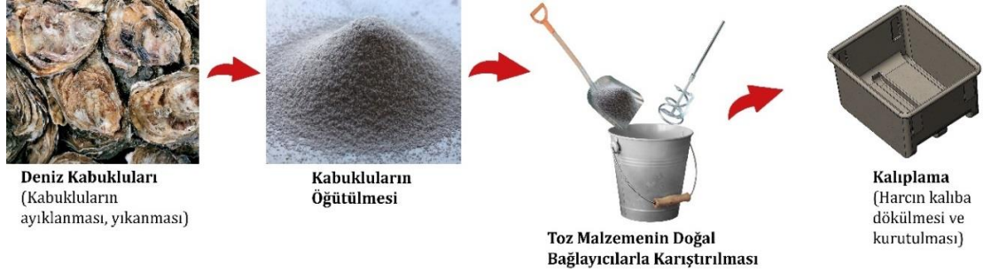
Şekil 7 - Deniz Taşı (Sea Stone) ürüne dönüşüm süreci.
