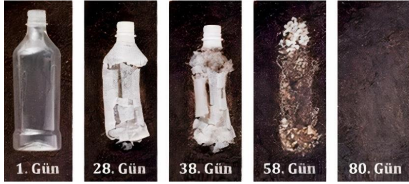
Şekil 1. Biyobozunur malzemenin doğada yok oluş süreci. (Bozkurt, 2016).
