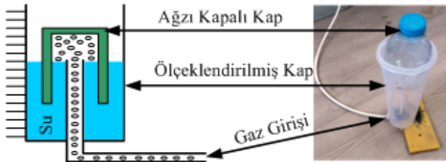
Şekil 10. Manometrenin fiziksel bağlantısı ve görünümü (The physical connection and the view of the manometer)
