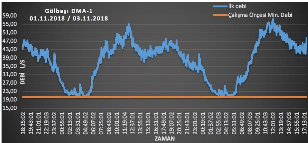
Şekil 3. 2018 yılı DMA-1 bölgesi çalışma öncesi debi değerleri ve minimum gece debi miktarı.
