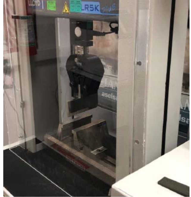
Şekil 4. LLOYD LR5K Plus üç nokta eğme test cihazı (LLOYD LR5K Plus three point bend test machine)
