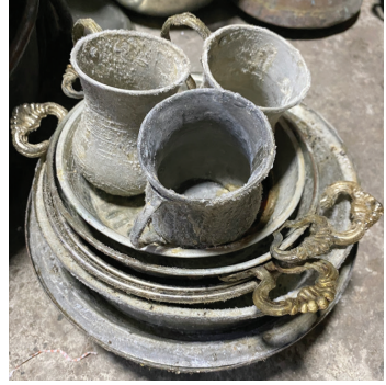
Fot. 18: Özcan Yıldırım, korozyona uğramış bakır kap kaçaqlar.
