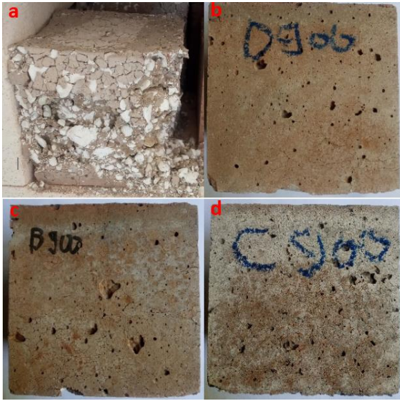
Şekil 8. 900°C sıcaklık etkisinden sonra farklı agregalar ile hazırlanan numuneler (a: kireçtaşı, b: dere, c: bazalt, d: cüruf) / Specimens produced with different aggregates after exposure to 900°C (a: limestone, b: river, c: basalt, d: slag)
