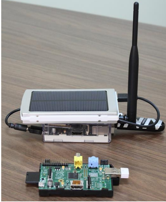
Şekil 6. "Raspberry Pi" tek kartlı bilgisayar kullanılarak tasarlanmış ağ geçidi
