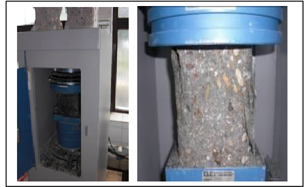
Resim 3. Basınç Deney cihazı ve kırılan numune
