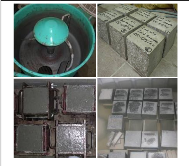
Resim 2. YDKYB'lerin karıştırılması yerleştirilmesi ve kür edilmesi
