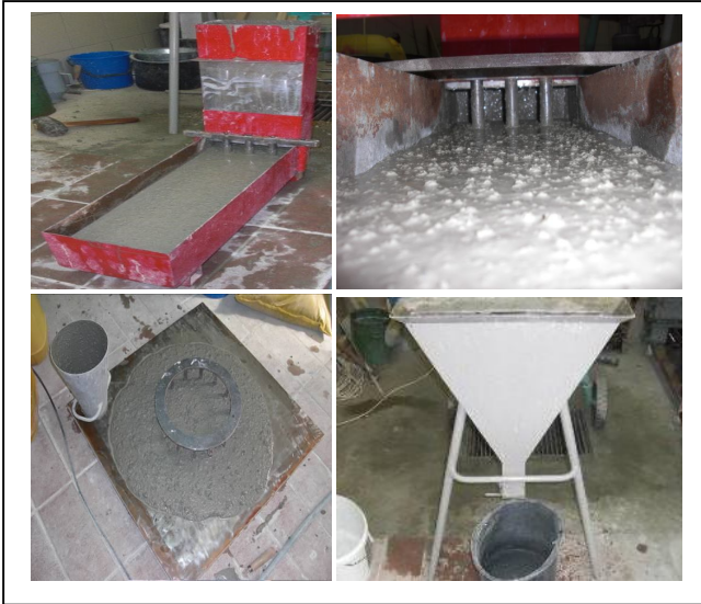
Resim 1. YDKYB için taze beton deneyleri
