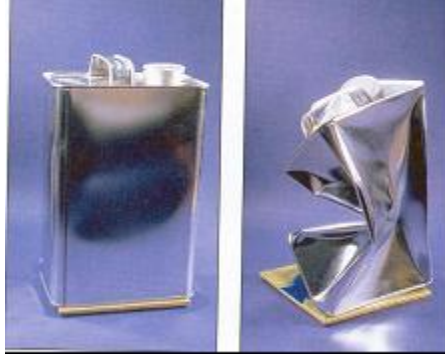
Şekil 6. Eğer içerisindeki tüm hava boşaltılırsa bir odadaki hava basıncı metal bir kutuyu çökertir (McKnight,1996: 108) (Figure 6. Normal air pressure in a room will collapse a metal can if all the air within it is evacuated)
