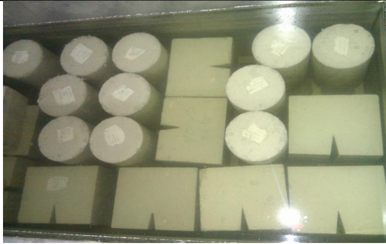
Şekil 3. Deney numunelerinin kürü (Figure 3. Curing of test samples)
