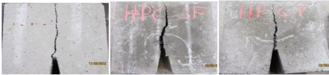
Şekil 6. Normal ve yüksek dayanımlı lifli betonlarda kırılma şekilleri (Figure 6. Fracture types of ordinary and high performance concrete with fiber)
