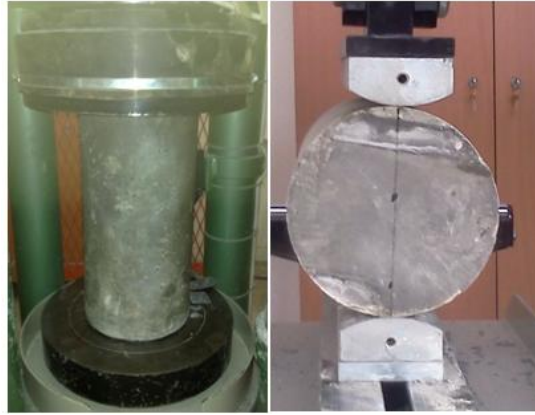
Şekil 4. Merkezi basınç ve yarmada çekme deneyleri (Figure 4. Compressive and tensile at split tests)
