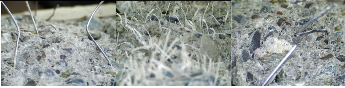
Şekil 9. Çelik ve polipropilen liflerin beton içinde dağılımı (Figure 9. The distribution of steel and polypropylene fibers in concrete)
