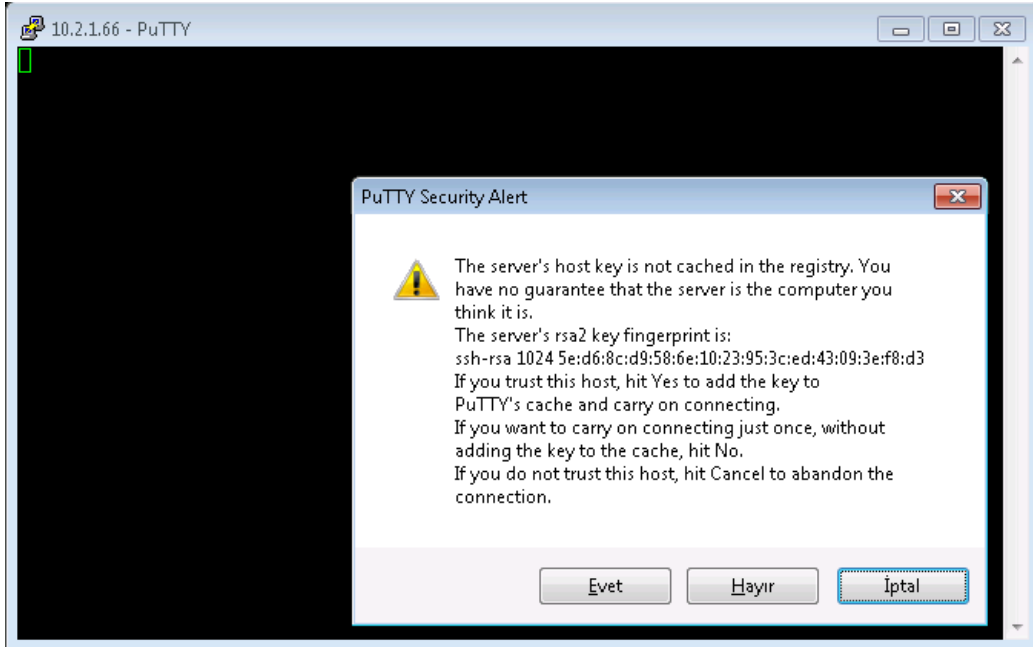
Şekil 1. SSH ile anahtarlama cihazı bağlantısı (Figure 1. SSH connection with the switching device)
