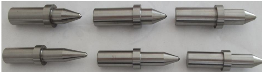
Şekil 2. Takımların geometrik boyutları a) Takımın geometrisi b) WC takımların fotoğrafları c) HSS takımların fotoğrafları (Figure 6. The tool geometry a) Tool geometry b) The pictures of WC tools c) The pictures of HSS tools
