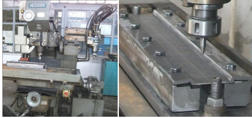
Şekil 1. Deneysel düzeneği ve bağlama aparatı (Figure 1. Experimental setup and binding apparatus)
