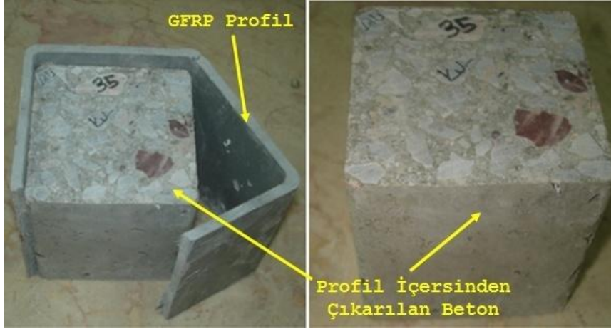
Şekil 5. Profil içersinden çıkarılan kür edilmemiş beton numunesi (Figure 5. Extracted concrete specimen from profile)
