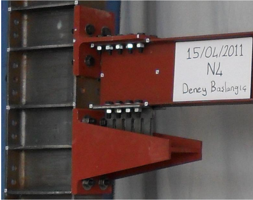
Figure 3. Detail of connection (Şekil 3. Bağlantı detayı)
